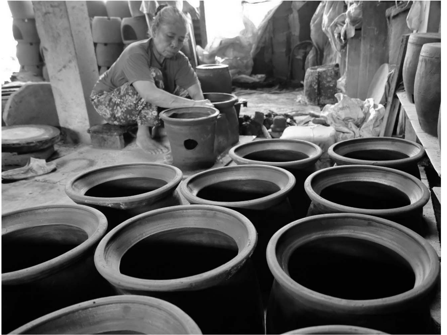
PRODUKSI GERABAH : Perajin menyelesaikan pembuatan tungku berbahan tanah liat di sentra kerajinan gerabah Desa Kundsari, Kedu, Temanggung, Sabtu (7/2/2026). Menurut perajin, curah hujan tinggi mengakibatkan produksi gerabah menurun hingga 60 persen dibanding saat musim kemarau yaitu dari 500 buah per bulan menjadi hanya 200 buah per bulan karena proses pengeringan yang memakan waktu lama.
